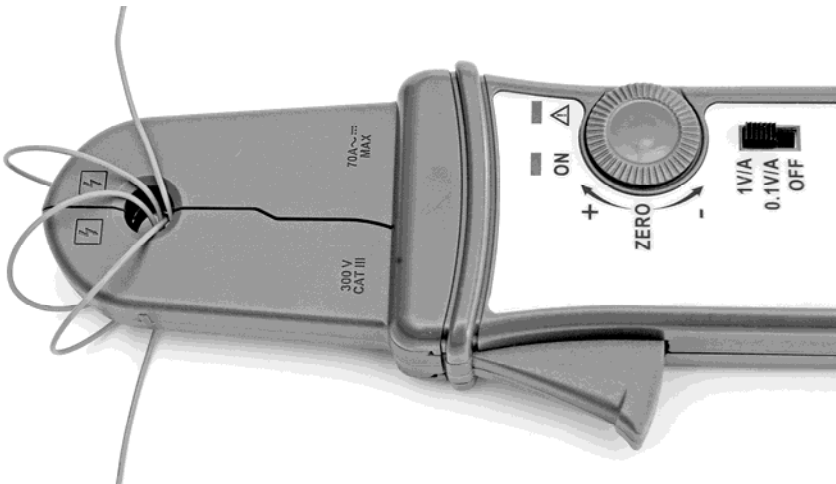
圖 4:提高電流靈敏度方式
