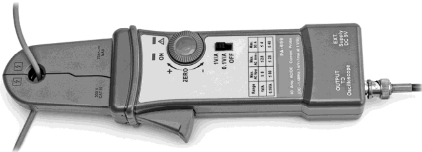
圖 2:連接到 PA-699 電流測試鉗
