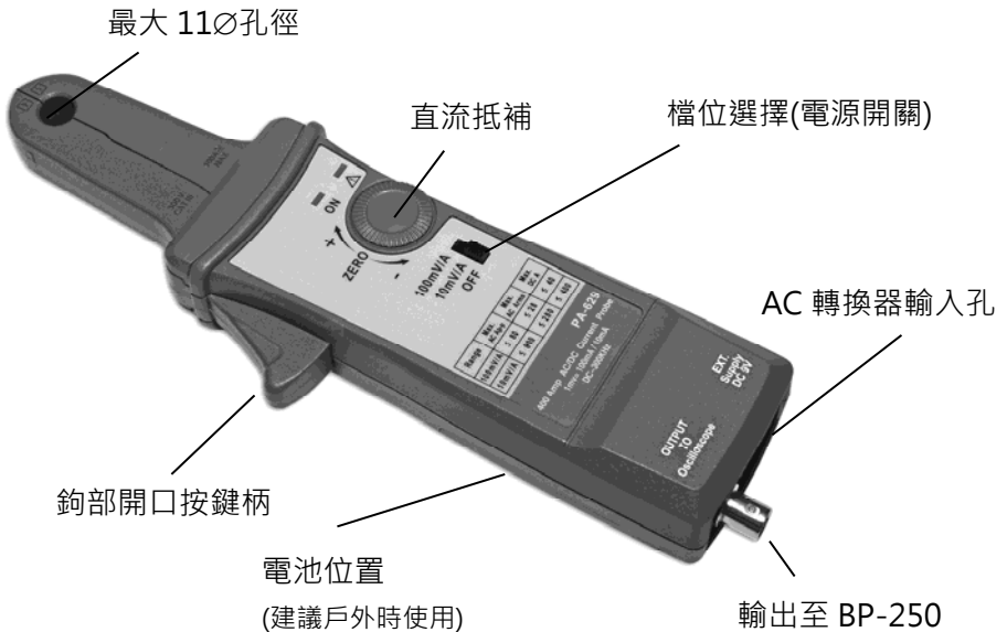
圖 1: PA-659 電流探測鉗上的控制及指示。
