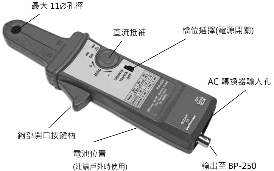
圖 1: PA-629 電流探測鉗上的控制及指示。
