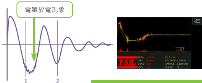
檢測線圈絕緣品質是否有放電現象
